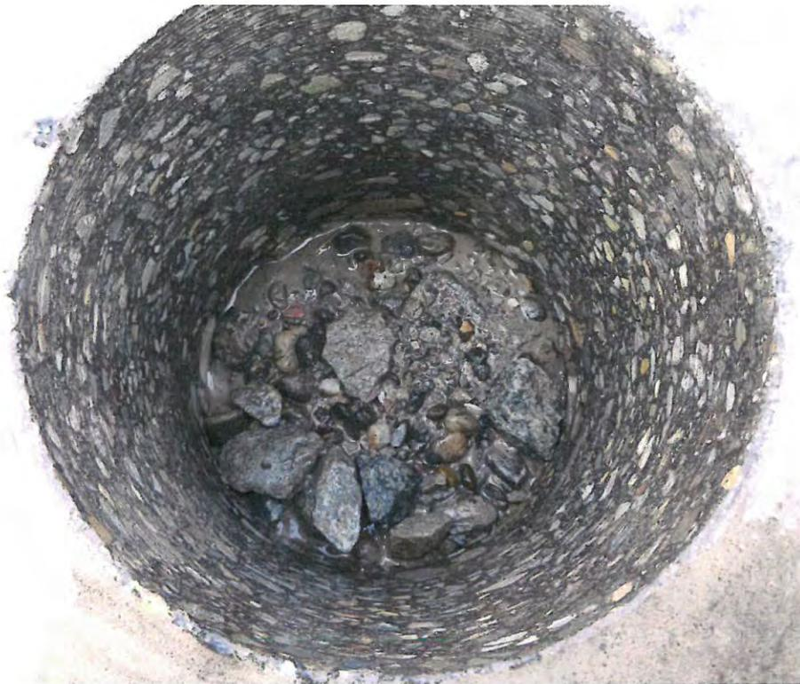
Bild 3: Blick in das Bohrloch von Bohrkern Ste1
