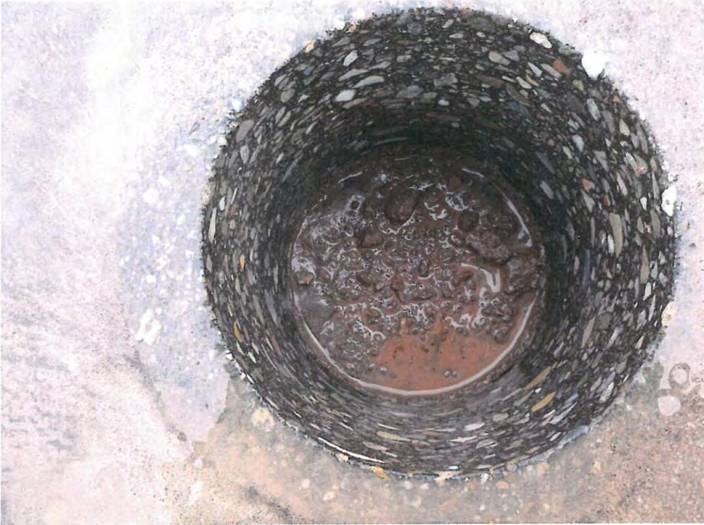
**Bild 9: Blick in das Bohrloch von Bohrkern Ste3**
