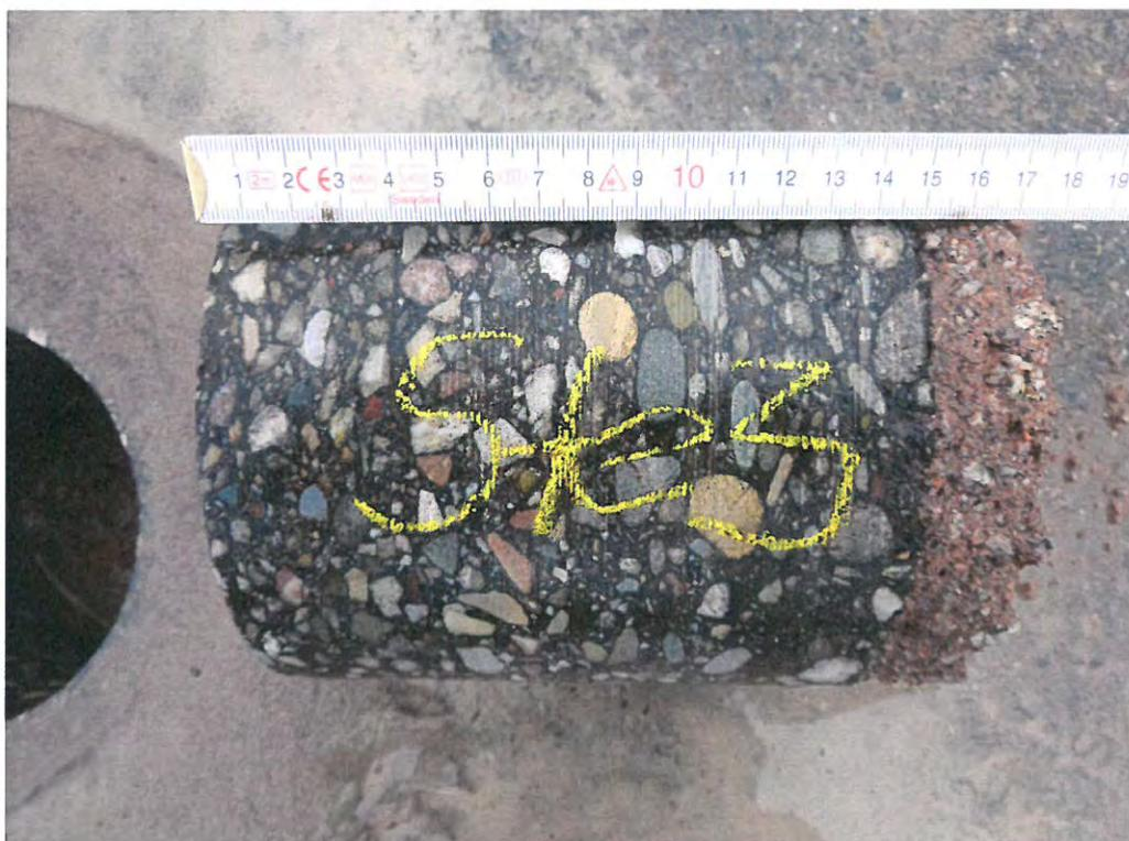
Bild 8: Bohrkern Ste3 nach der Entnahme
