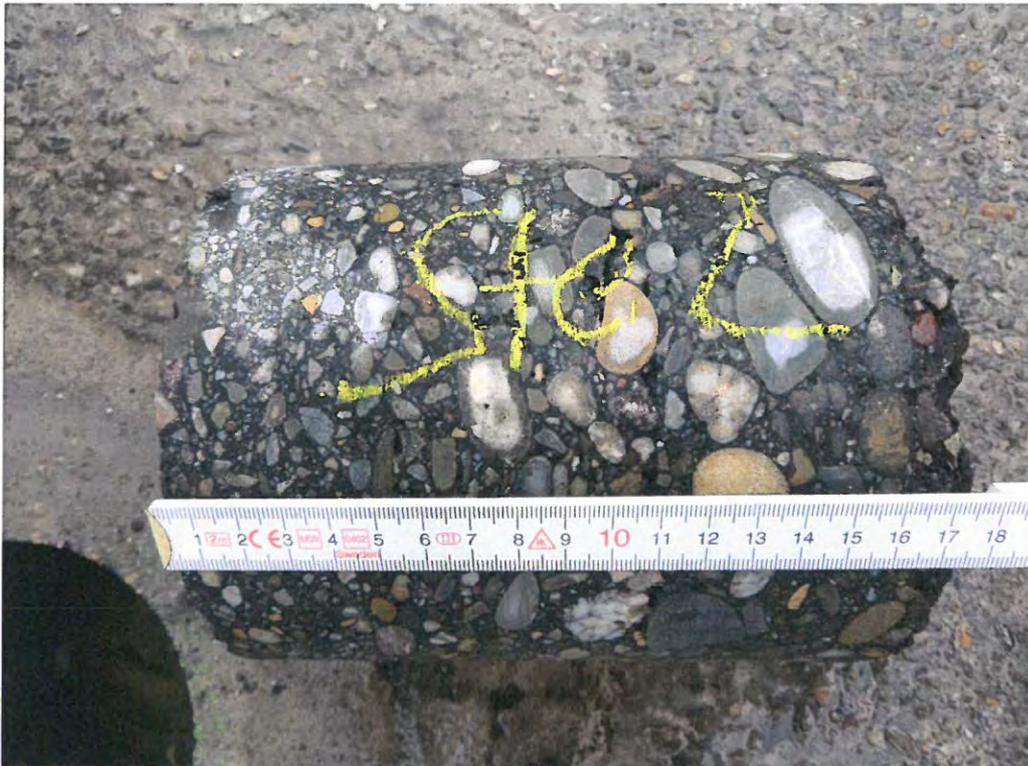
**Bild 5: Bohrkern Ste2 nach der Entnahme**
