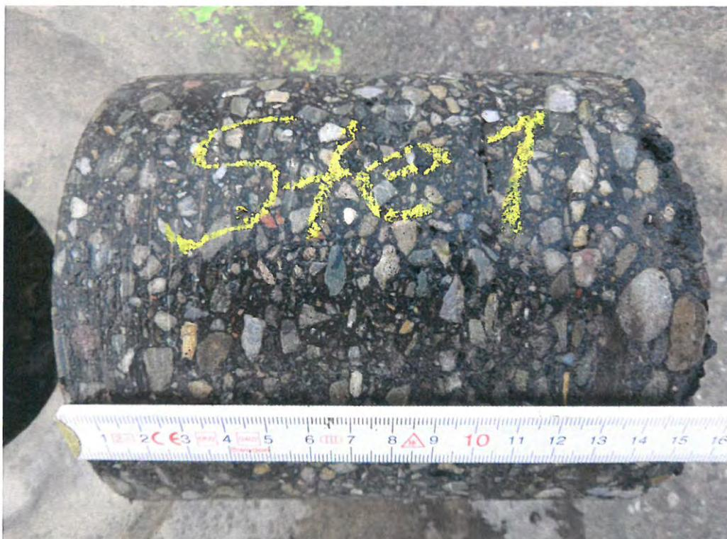
Bild 2: Bohrkern Ste1 nach der Entnahme
